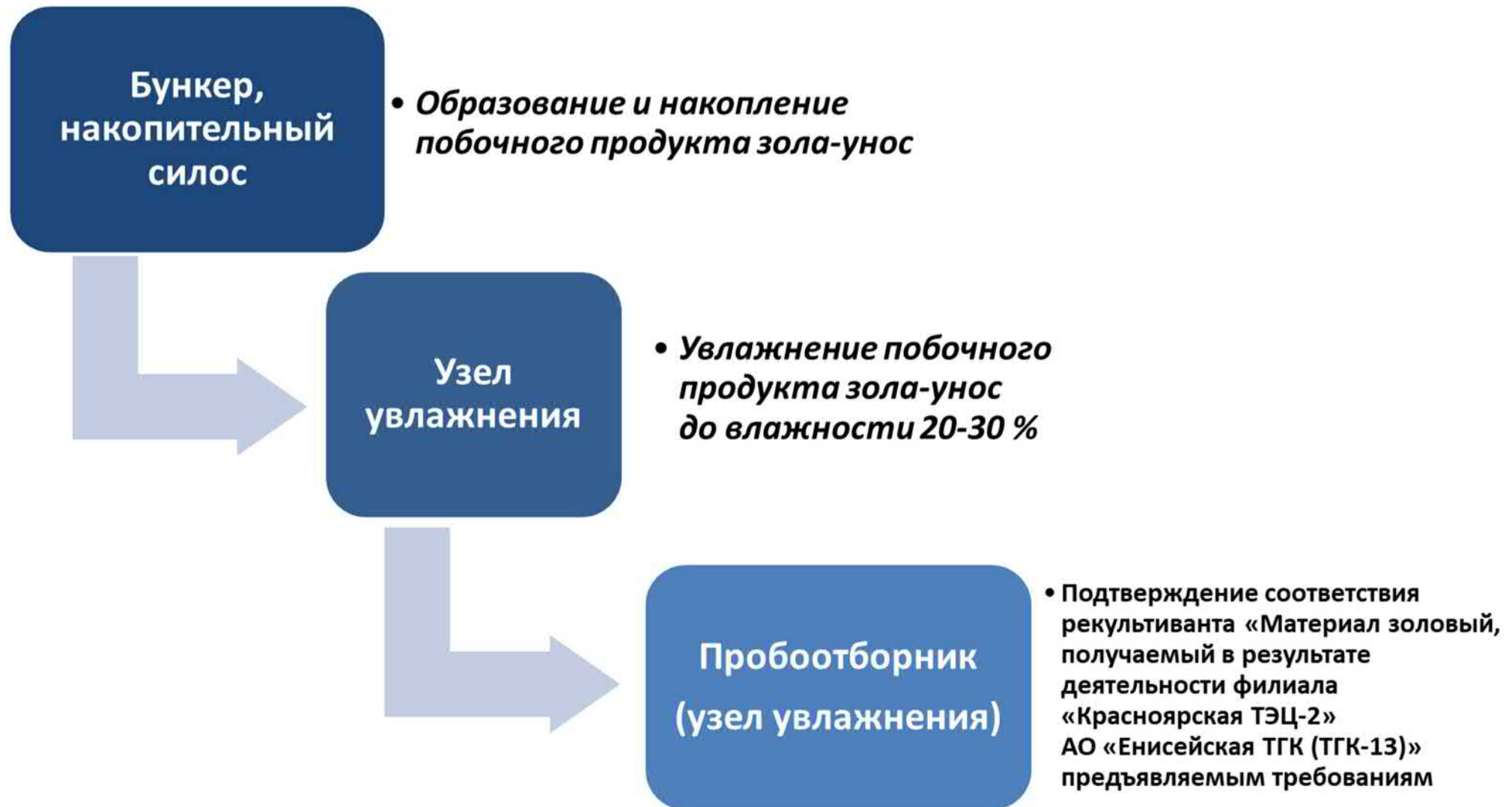
Рисунок 3 – Блок-схема производства рекультиванта «Материал золовый, получаемый в результате деятельности филиала «Красноярская ТЭЦ-2» АО «Енисейская ТГК (ТГК-13)»
