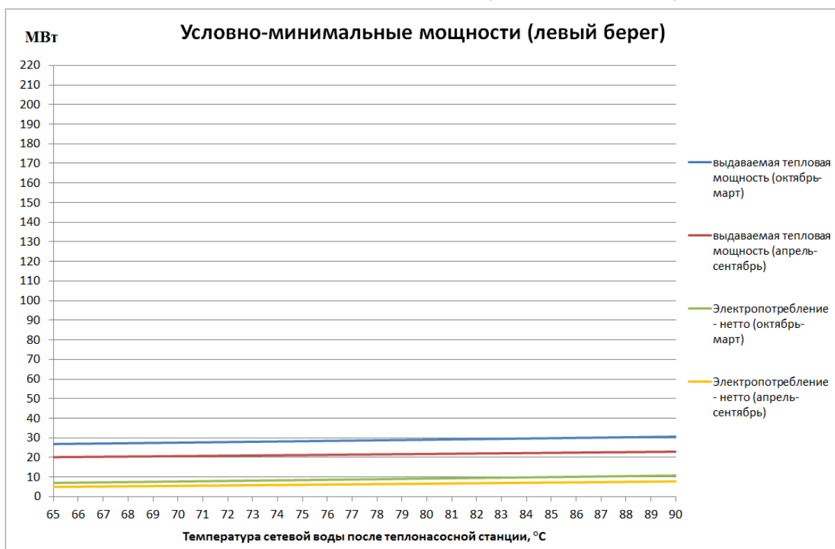
Рисунок 5.3 - Условно-минимальная тепловая мощность левобережной теплоснасосной станции
