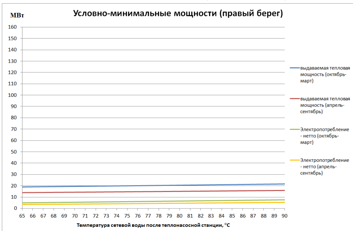
Рисунок 5.7 - Условно-минимальная тепловая мощность правобережной теплоснасосной станции
