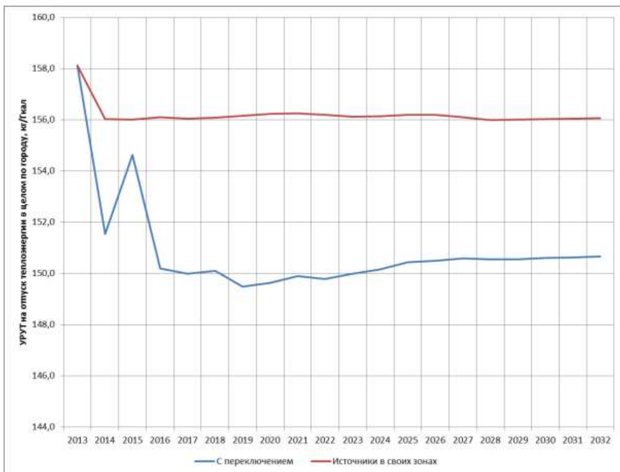
Рисунок 7.3 – Снижение УРУТа в целом по городу при реализации мероприятий схемы теплоснабжения
