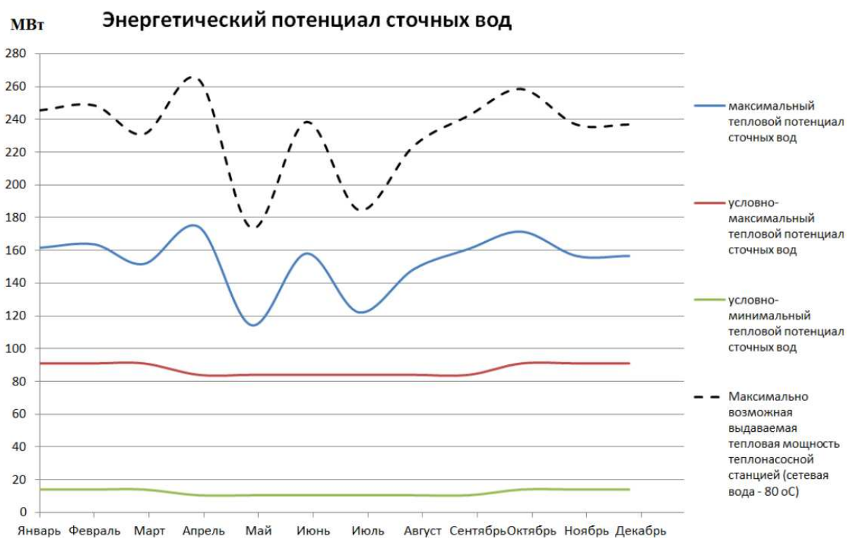
Рис. 5.9. Энергетический потенциал сточных вод правобережной станции аэрации, включая максимально возможную тепловую мощность, выдаваемую теплонасосной станцией
