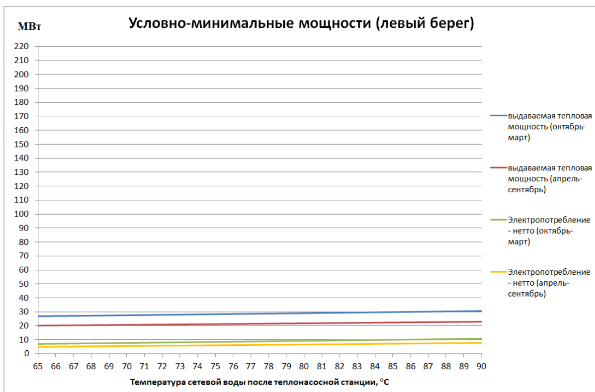
Рис. 5.3. Условно-минимальная тепловая мощность левобережной теплонасосной станции
